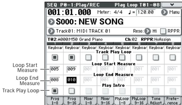
上図の設定例では、最初の小節からプレイバックした場合、次のように、設定区間を繰り返します。
