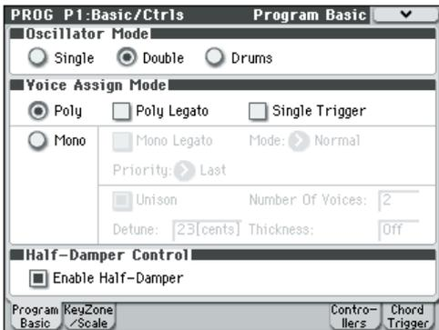
Single (シングル・プログラム) は 1 オシレーターを、Double (ダブル・プログラム) は 2 オシレーターを使用します。各オシレーターはクロスフェード・ベロシティ・スイッチで切り替わるマルチサンプルです。デュアル・フィルター、EG、LFO などで音作りをします。
