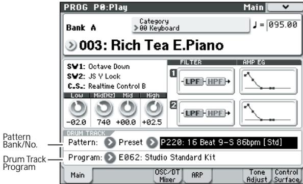
2. ドラムトラック・パターンを選びます。“Pattern (Pattern Bank)” でプリセットまたはユーザー・バンクを選び、“Pattern No.”でパターン・ナンバーを選びます。
