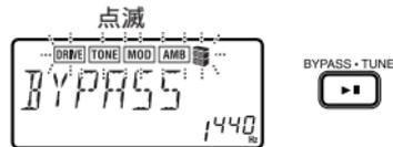
BYPASS・TUNE ボタンを1秒以上押すとミュート状態になり、音が出なくなります。エフェクト・チェーンが速く点滅して、約1秒間“MUTE”と表示されます。
