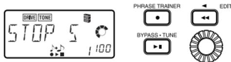
一時停止中に[ ◀◀ ]ボタンを押すと、録音したフレーズの先頭に戻ります。
