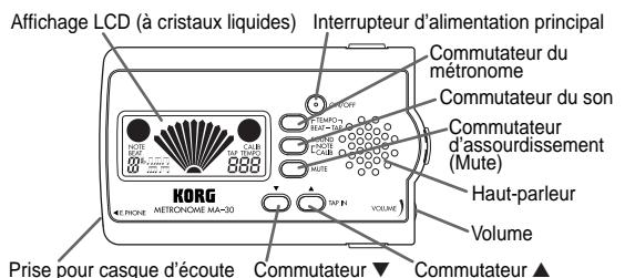
Appuyer sur l'interrupteur d'alimentation principal pour mettre l'appareil sous tension.
