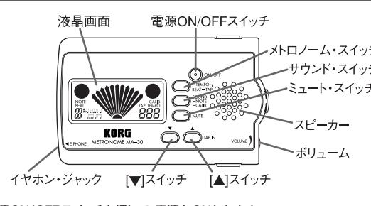
電源ON/OFFスイッチを押して、電源をONにします。
