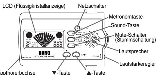
Drücken Sie den Netzschalter, um das Gerät ein-/auszuschalten.
