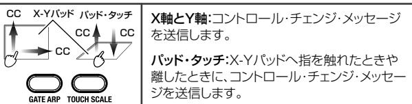
X軸とY軸:コントロール・チェンジ・メッセージを送信します。
