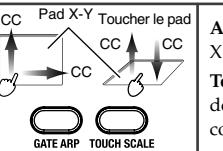
Axes X et Y: Le fait de glisser le doigt sur l'axe X ou Y transmet des commandes de contrôle.
