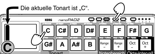
Halten Sie den KEY/RANGE-Taster gedrückt, während Sie das Pad betätigten, das der gewünschten „Key“, „Note Range“ oder „Octave Shift“-Einstellung zugeordnet ist.
