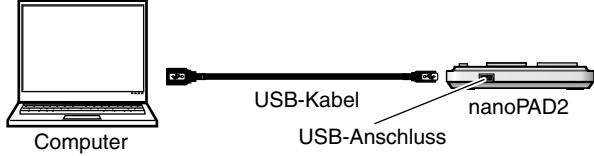
1. Über diesen Port können Sie das nanoKEY2 mit Hilfe eines USB-Kabels mit einem USB-Port Ihres Computers verbinden. Das nanoPAD2 wird eingeschaltet und die Netzanzeige leuchtet.
