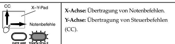
**X-Achse:** Übertragung von Notenbefehlen.
