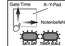
**X-Achse:** Übertragung von Notenbefehlen.
