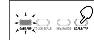
你可按照心目中的速度去拍打SCALE / TAP键几次来设定Gate Arpeggiator(闸门琶音器)的速度。GATE ARP键指示灯会与拍打速度同步闪烁。按SCALE/TAP键两次或以上可从而更改所需速度。拍打的次数越多，设定的速度就越准确。
