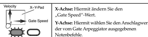
**X-Achse:** Hiermit ändern Sie den „Gate Speed“-Wert.
