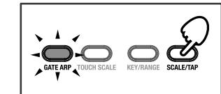
SCALE/TAPボタンを一定間隔で押すことにより、ゲート・アルペジエーターのテンポを設定します。GATE ARPボタンはテンポに合わせて点滅します。SCALE/TAPボタンを2回以上押すとテンポは変更されます。ボタンを複数回押すと、より精度を高めることができます。
