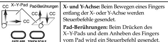
**X- und Y-Achse:** Beim Bewegen eines Fingers entlang der X- oder Y-Achse werden Steuerbefehle gesendet.
