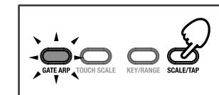
Bei Bedarf können Sie das Gate Arpeggiator-Tempo auch einstellen, indem Sie den SCALE/TAP-Taster mehrmals im gewünschten Tempo drücken. Die Diode des GATE ARP-Tasters blinkt jeweils im aktuellen Tempo. Bereits nach der zweiten Betätigung des SCALE/TAP-Tasters ändert sich das Tempo. Wenn Sie den Taster jedoch häufiger drücken, ist die Tempoeinstellung genauer.
