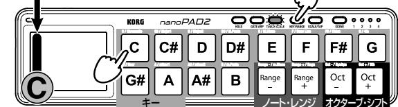
KEY/RANGEボタンを押しながら、設定するキーのトリガー・パッドやノート・レンジのトリガー・パッド、またはオクターブ・シフトのトリガー・パッドを押します。
