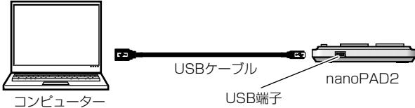
1. nanoPAD2とコンピューターのUSB端子をUSBケーブルで接続します。電源が入り、パワーLEDが点灯します。
