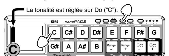
Maintenez le bouton KEY/RANGE enfoncé et appuyez sur le pad de déclenchement permettant de régler le paramètre "Key", "Note Range" ou "Octave Shift".
