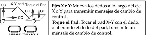
Ejes X e Y: Mueva los dedos a lo largo del eje X o Y para transmitir mensajes de cambio de control.
