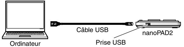
1. Reliez le nanoPAD2 à un port USB de votre ordinateur avec un câble USB. Le nanoPAD2 est mis sous tension et son témoin d'alimentation s'allume.
