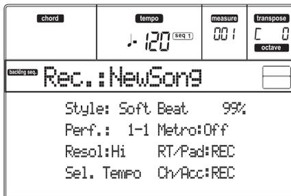
2. 削除して録り直したいトラックを REC に設定します。
