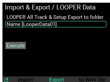
**Note:** “Name”にカーソルを合わせてENTERボタンを押すと、名前の変更ページが表示されます。→ [Nameダイアログの操作（名称変更の方法）](#)
