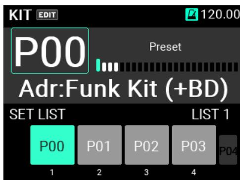
SET LISTモードでは、TRACK1~4ボタンがKITの切り替えボタンとして動作します。
