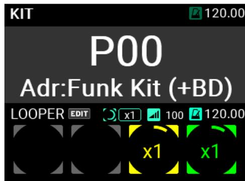
「トラック長」「レベル」はトップ・ページ上で変更することができ、カーソルをVALUEノブで移動させ、ENTERボタンで選択状態に移行します。
