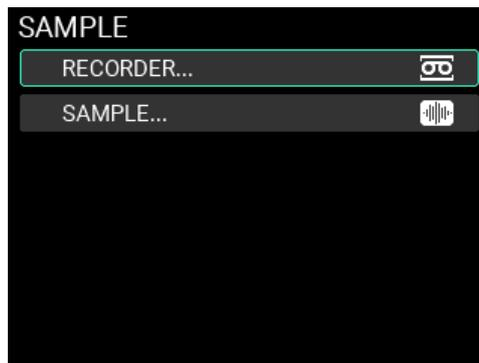
VALUEノブでRECORDERかSAMPLEを選択後、ENTERボタンを押してRECORDERページあるいはSAMPLEページに入ることができます。
