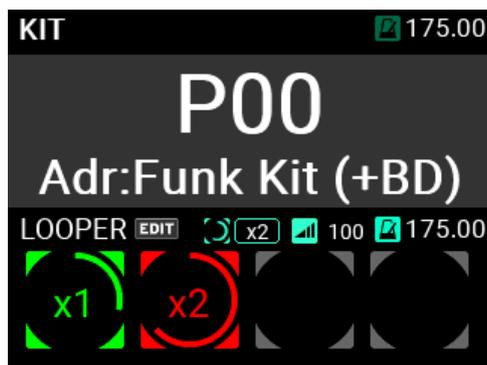
トラック2は、トラック1の2倍長の録音が完了するとオーバーダブに移行します。
