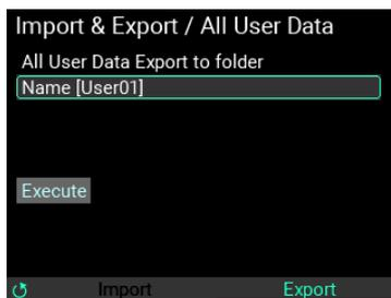
“Name”にカーソルを合わせてENTERボタンを押すと、名前の変更ページが表示されます。→[Nameダイアログの操作\(名称変更の方法\)](#)。
