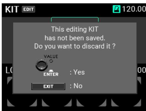
保存しないで電源を切る場合は、ENTERボタンを押します。保存したい場合は、EXITボタンを押して電源を切ることがキャンセルし、設定を保存してから、再度電源ボタンを押して、電源を切ってください。
