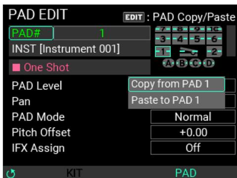
PADの設定をコピーする場合は“Copy from PAD #”をVALUEノブで選択しENTERボタンを押します。その後、コピーしたいPADを“PAD#”で選択し、EDITボタンを押し、表示したポップアップメニューで“Paste to PAD #”をVALUEノブで選択しENTERボタンを押します。
