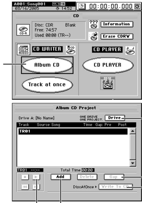
• TR01を選び(反転表示)、AddボタンをクリックしてAdd TRダイアログ表示します。
