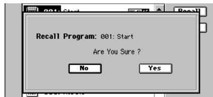
🚫 44.1kHz及び48kHzのソングで保存したプログラムは44.1kHz、48kHzのどちらのソングでも呼び出しできます。
