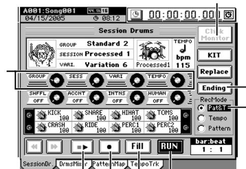
コントロール・ツマミ1～4を回して、先頭小節のドラム・パターンを選択します。
