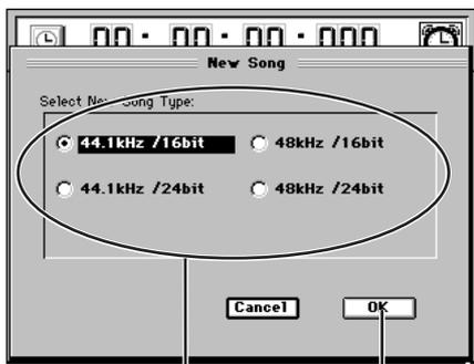
作成するソングのサンプリング周波数/ビット数の設定のラジオ・ボタンをクリックします。
