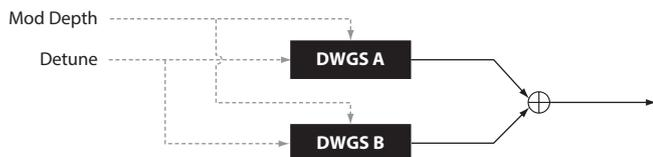
Ces types d'oscillateurs produisent les simples formes d'onde DWGS ('Digital Waveform Generator System' ou système de générateur de forme d'onde numérique) qu'on retrouve sur des synthés numériques comme le Korg DW-8000.
