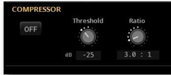
El control **Threshold** establece el nivel de canto en y por encima del cual se producirá la cantidad de reducción de ganancia (compresión) especificada por el control Ratio. El rango es de 0 dB a -40 dB: 0 dB es la señal de entrada más fuerte que el procesador de voz puede aceptar sin distorsión y -40 dB es una señal muy silenciosa. Si canta consistentemente más bajo que el Umbral, no escuchará ninguna compresión. Un buen ajuste para la experimentación es -10 dB.
