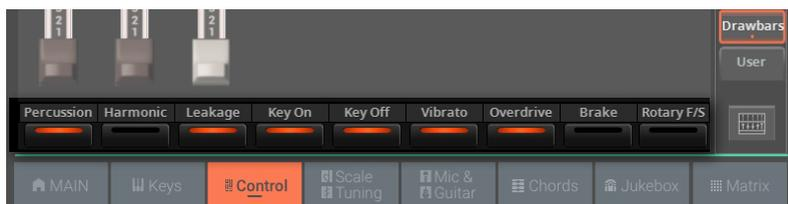
Tenga en cuenta que los controles Vibrato/Chorus, Overdrive, Brake y Rotary Slow/Fast solo funcionarán si los siguientes Insert FX se seleccionan y habilitan para el sonido de tiradores digitales: Organ Vibrato/Chorus, CX-3 Amp, uno de los Rotary Speakers.
