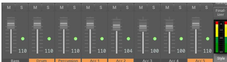
Vigile mientras ajusta el volumen y los niveles de ecualización, o el nivel interno de los efectos. El color de las barras advertirá sobre el riesgo de sobrecarga y distorsión de las salidas de audio finales.
