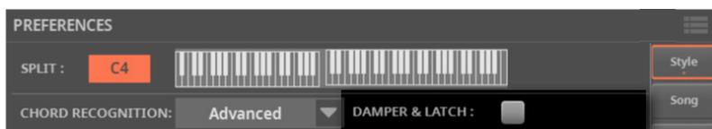
**2** Seleccione la casilla de verificación **Damper&Latch** para que el acorde reconocido se mantenga presionado durante el tiempo que se mantenga presionado el pedal Damper.
