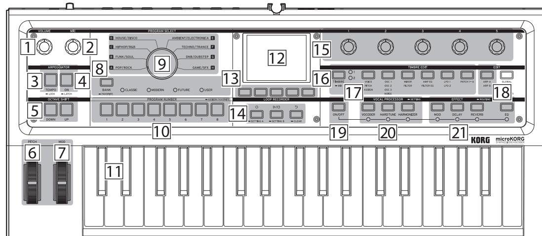
1 同时按下 VOCODER 按钮 20 和 ON/OFF 按钮 19 可打开/关闭声码器。
