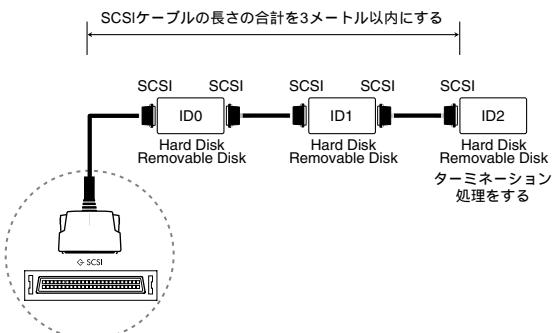
外部SCSIデバイスの電源をオンにしてから、本体の電源をオンにします。
