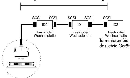
⑤ Schalten Sie das (die) externe(n) SCSI-Gerät(e) ein und schalten Sie zuletzt das Instrument (in dem die EXB-SMPL eingebaut ist) ein.
