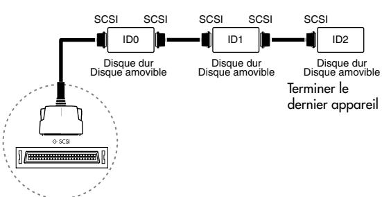
⑤ Mettre le (ou les) appareil(s) SCSI externe(s) sous tension avant de mettre l'instrument (dans lequel la carte EXB-SMPL est installée) sous tension.
