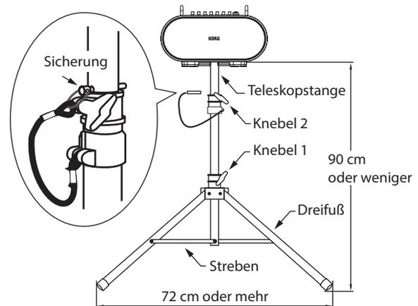
1. Lösen Sie Knebel 1 und ziehen Sie den Dreifuß ausreichend weit aus. Öffnen Sie den Dreifuß komplett – die Streben sollen waagrecht stehen. Achten Sie darauf, dass der Abstand der Beine mindestens 72 cm beträgt.
