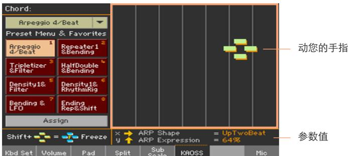
根据选定的预设，KAOSS垫上的网格将起变化。每个单元格对应于一数值（也称为“级”）。浅灰色的单元格是对应参数的默认值。
