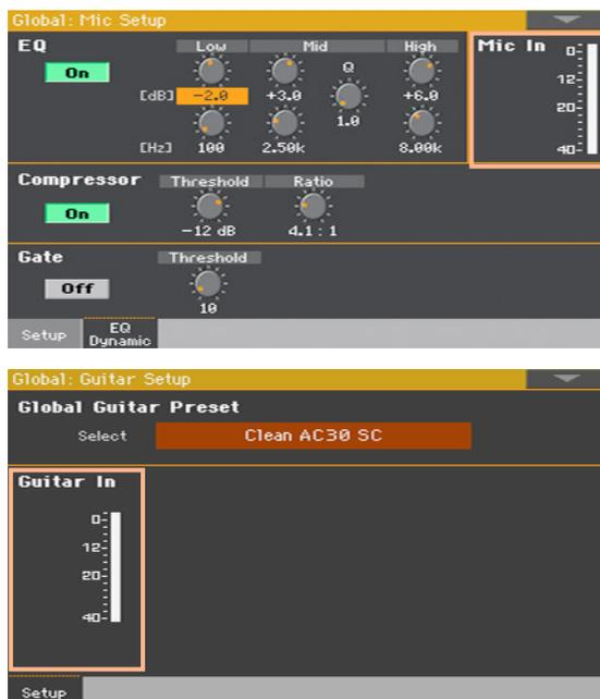
Avec un micro ou un dispositif de niveau ligne, essayez de maintenir le niveau pour que ce témoin reste vert la plupart du temps avec quelques apparitions oranges pour les crêtes de signal. N'allez jamais dans le rouge.
