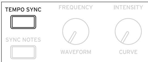
*On*: El LFO se sincroniza con el tempo del sistema, con su velocidad controlada por **Base Note** y **Multiply**.
