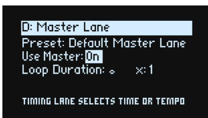
Cuando **Use Master** está activado (*On*), el carril Master reinicia el resto de Carriles después de un número específico de compases o de tiempo transcurrido; dependiendo de la activación/desactivación de **TEMPO** (a continuación). A diferencia de otros Carriles, Master no tiene pasos, por lo que la mayoría de los controles de Lane del panel frontal no se aplican.
