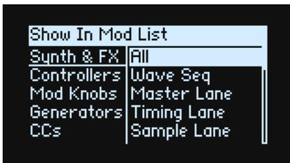
2. Pulse un botón de Carril, Envolvente, LFO o Efecto. Mueva un **MOD KNOB**, mantenga pulsado **ENTER** y mueva un controlador o toque una nota en el teclado (para Velocidad), envíe un mensaje MIDI; o bien, para las secciones Filter, Amp o Pitch, mueva un mando en esa sección. Utilice la lista en pantalla para realizar otras selecciones, como Key Track o los Procesadores de modulación.
