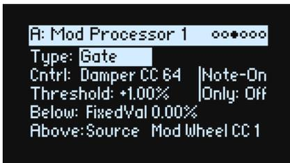
Permite cambiar entre dos fuentes de modulación (o valores fijos) utilizando una tercera fuente de modulación.
