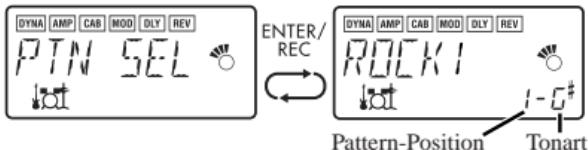
Insgesamt lassen sich bis zu 16 Patterns miteinander verketten. Bei Kombinationen von weniger als 15 Patterns selektieren Sie zum Abschluss „**PTN END**“. Durch Drücken der **ENTER/REC-Taste** verlassen Sie das CHAIN-Pattern-Auswahlfenster wieder.
