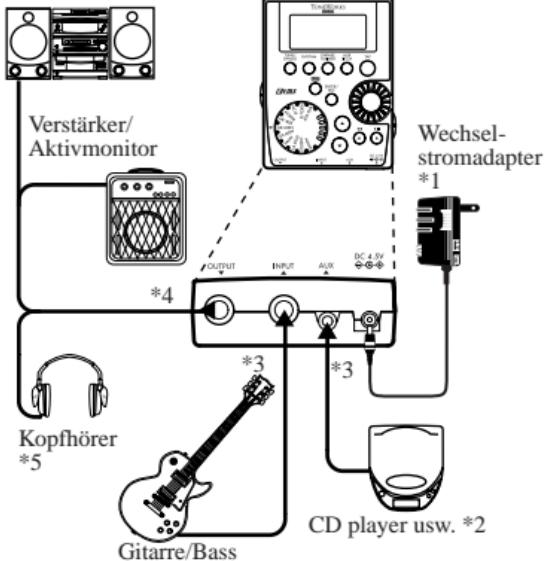
\*1 Verwenden Sie nur den empfohlenen Wechselstromadapter. (DC4.5V ).
