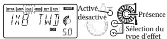
L'affichage de la valeur indiquera "Gt" pendant environ une seconde si vous avez sélectionné une enceinte pour ampli de guitare, ou "bA" si vous avez sélectionné une enceinte pour ampli de basse. Vous êtes libre d'utiliser une guitare AMP avec une basse CAB, ou une basse AMP avec une guitare CAB.
