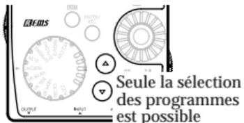
La fonction de verrouillage des touches s'annule lorsque l'appareil est mis hors tension. Vous pouvez également annuler cette fonction par le biais de "5. Définition de la fonction du disque de valeurs".
