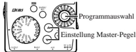
Wenn Sie die Funktion des **Value-Reglers** so ändern wollen, dass dieser den Master-Pegel regelt, halten Sie die Taste EXIT einmal gedrückt und drücken dann die **Taste ▲** oder schalten den Betriebsstrom ein.
